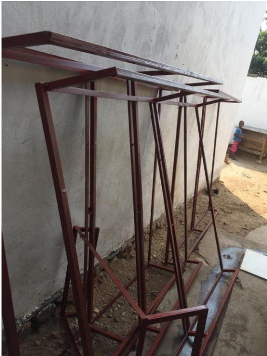
Lokale fabricage: het lassen en montage van stalen frames voor panelen en accukast
