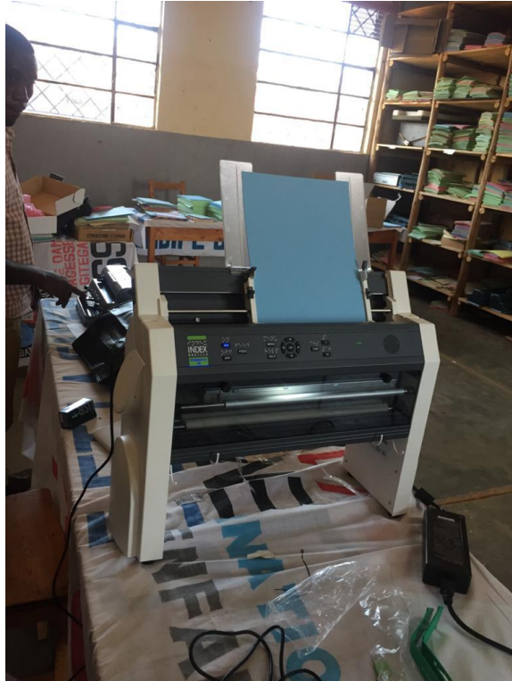
Onderhoud en reparatie: vervanging van de printmodule in een Everest DV-3 en test van de opnieuw goed werkende braille printer
