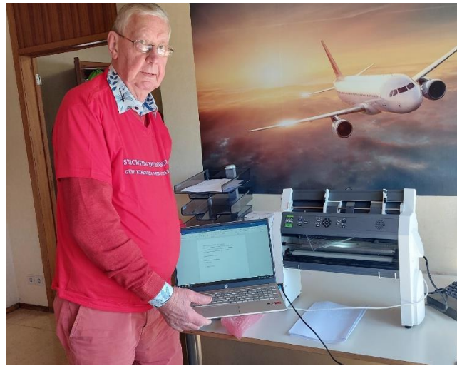
Configuratie van een Index Braille, Everest DV5 printer met de laptop, voorzien van een Franstalig toetsenbord en programmatuur voor braille productie.
