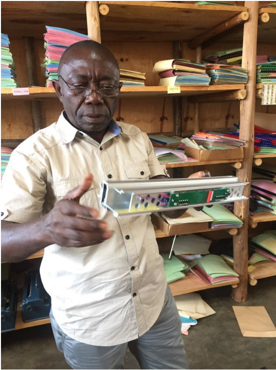
Onderhoud en reparatie: vervanging van de printmodule in een Everest DV-3 en test van de opnieuw goed werkende braille printer
