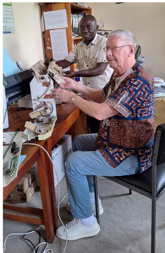
Reparatie van de allereerste brailleprinter In Burundi, door ons in 2018 geïnstalleerd
